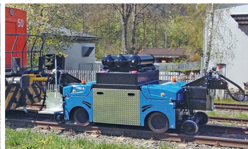
ZAGRO E-MAXI XL mit Waggonbremsanlage und Trittplattform ZAGRO E-MAXI XL with wagon brake system and foothold
