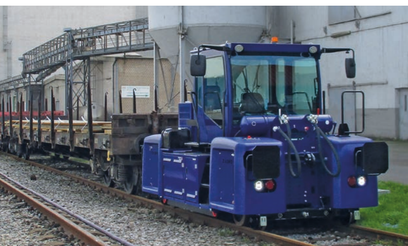
ZAGRO E-MAXI XL Hybrid mit Waggonbremsanlage ZAGRO E-MAXI XL Hybrid with wagon brake system
