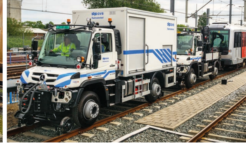
Unimog im Tandembetrieb zur Leistungssteigerung Unimog in tandem operation for high performance
