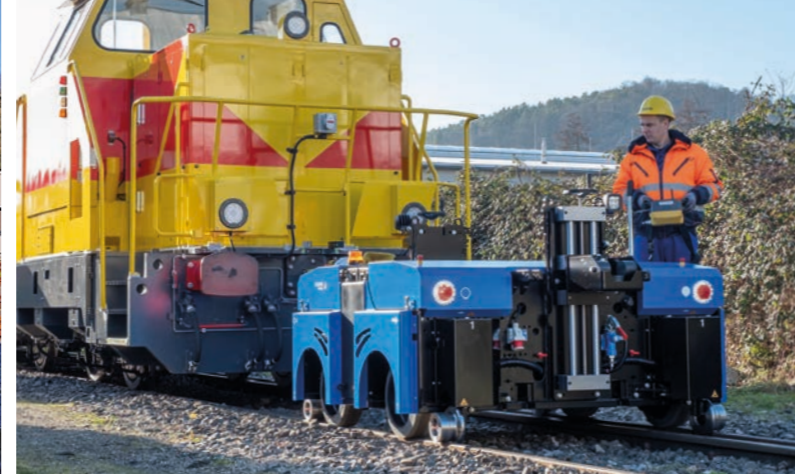
ZAGRO E-MAXI M mit höhenverstellbarer Kupplungsaufnahme ZAGRO E-MAXI M with height adjustable coupler receiver
