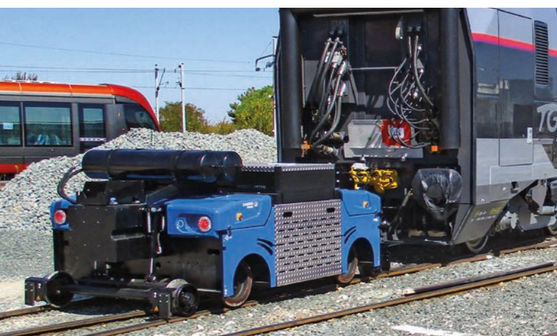
ZAGRO E-MAXI XL mit Waggonbremsanlage ZAGRO E-MAXI XL with wagon brake system
